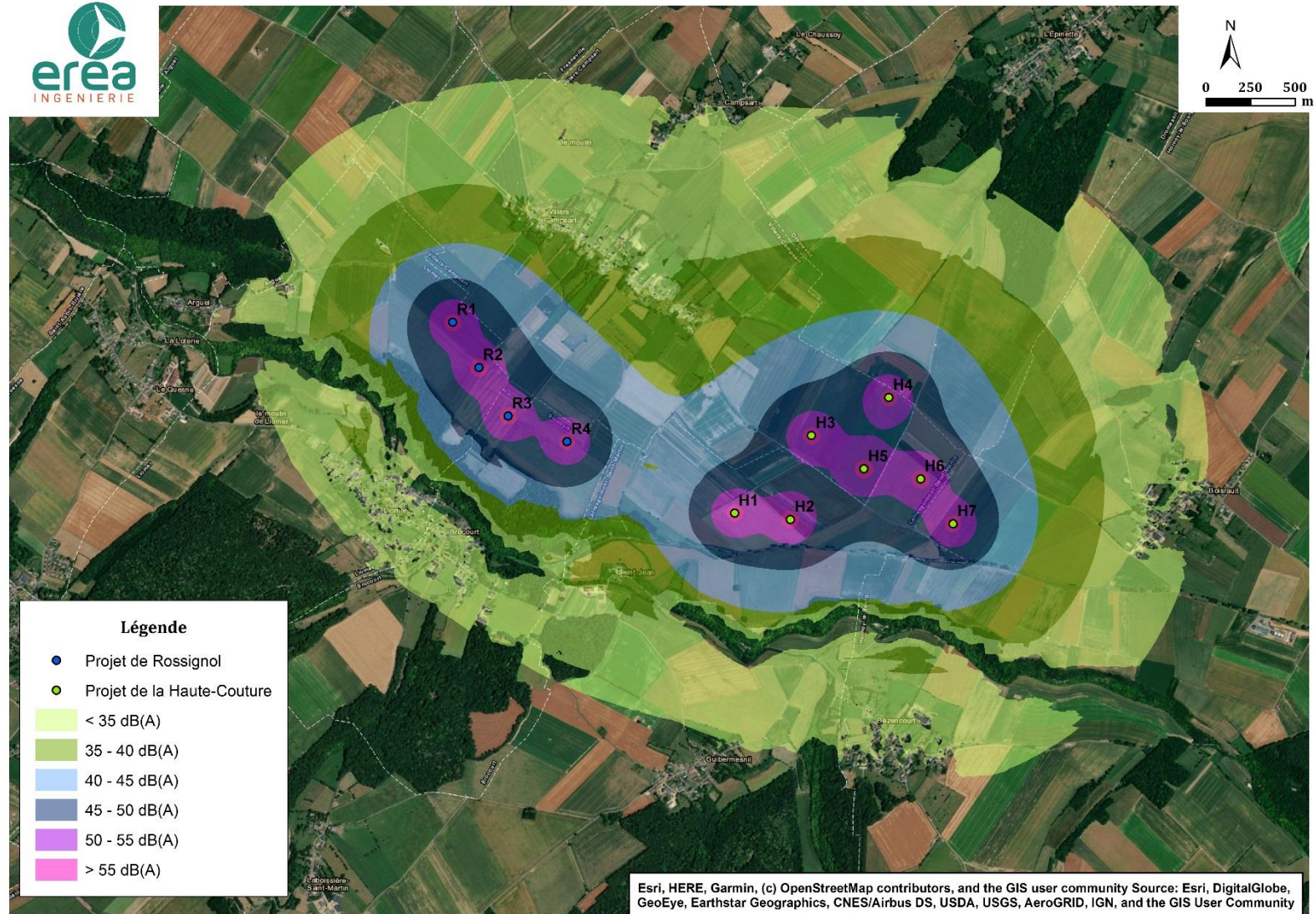
Isophones à une hauteur de 2 m du sol de la contribution des éoliennes VESTAS V110 2,2 MW pour une vitesse standardisée de 10 m/s et une direction Sud-Ouest
