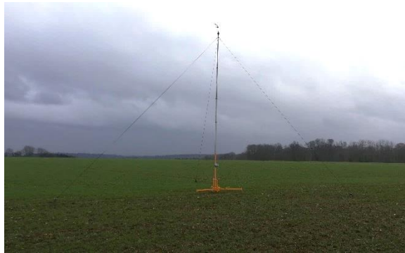
Photographie du mât de mesures météorologiques
